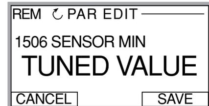
15. El paso final es ingresar la presión requerida en el sistema. Una vez finalizada la programación anterior, presione la tecla EXIT tres (3) veces hasta regresar a la primera pantalla visualizadora de control. Luego presione la flecha hacia arriba o hacia abajo para seleccionar la presión requerida en el sistema. Una vez que la presión ha sido seleccionada, presione la tecla verde START del teclado.
